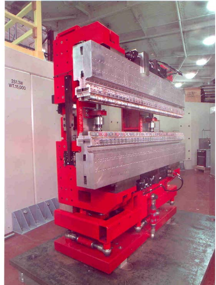
ALS EPU50 (1998) Pure permanent magnet technology, elliptically polarizing capability
